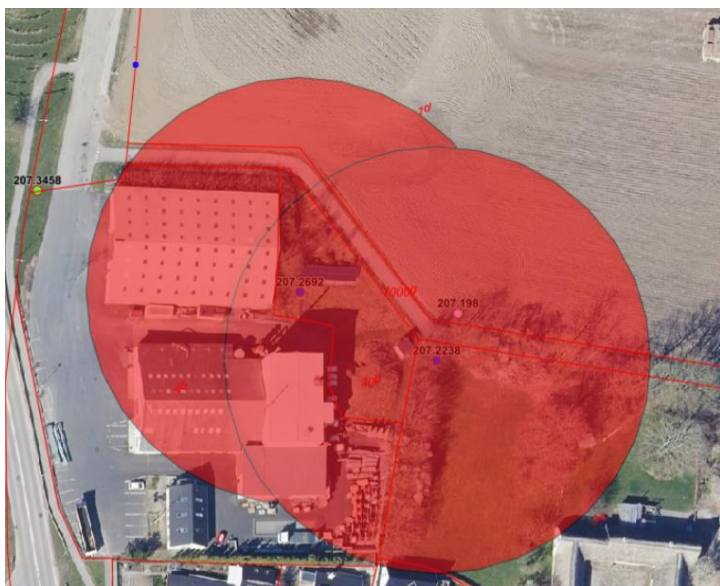
Markstakke kan ikke placeres inden for 50 meter fra Stærkende Vandværks 2 boringer DGU nr. 207.2692 og 207.2238
